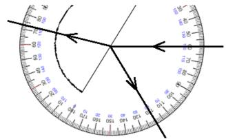
Example:  $\theta_i = 30^\circ$ ,  $\theta_a = 30^\circ$ ,  $\theta_p = 17^\circ$
